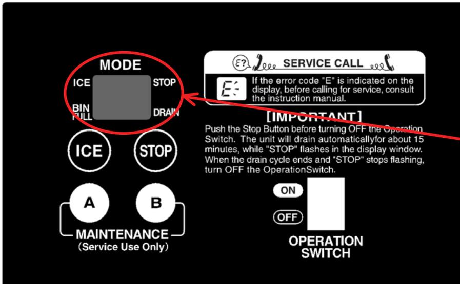
Lorsqu'une erreur se produit, « E\_ » ou « c\_ » apparaît sur l'afficheur. Certaines erreurs « c\_ » ne s'affichent pas et doivent être vérifiées avec le journal des erreurs.
